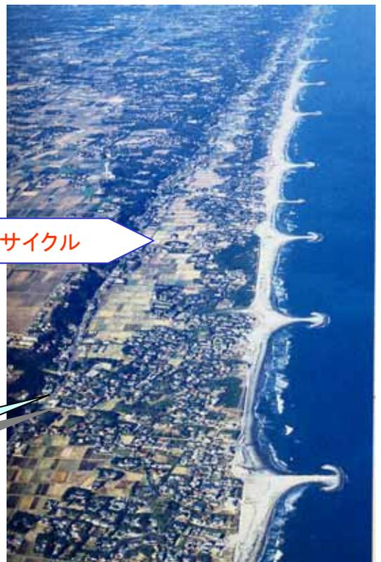
養浜した砂は、ヘッドランドの歩留り効果により、すぐには流出せずヘッドランド間で滞留し、海浜が安定しています。
