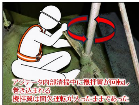
②内部で作業中、攪拌機が作動 作業員は攪拌機にしがみつく
