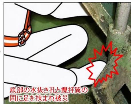
③右足が排水孔に挟まり、負傷
