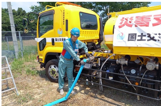
現地での給水作業
