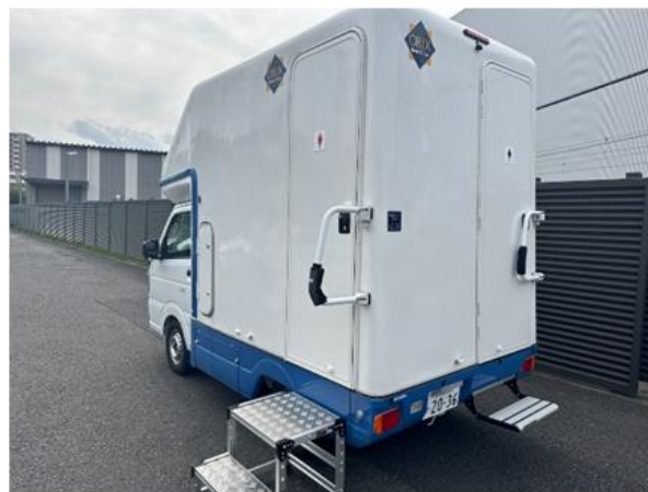
【男女別（洋式トイレ型）自走式仮設水洗トイレカー】
