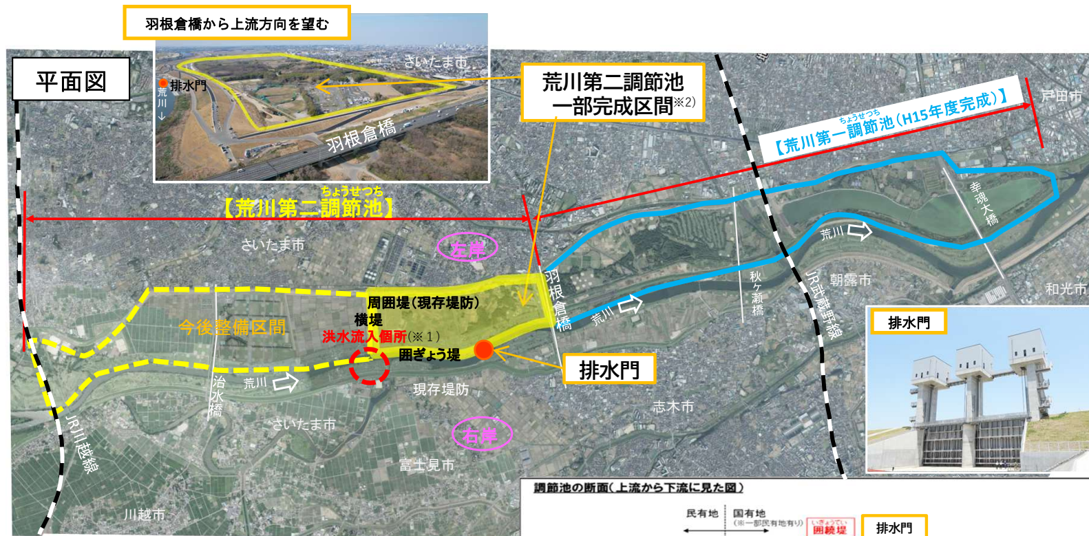
【参考】一部完成区間における洪水調節の仕組み
