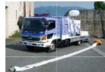
排水ポンプ車(1台)
