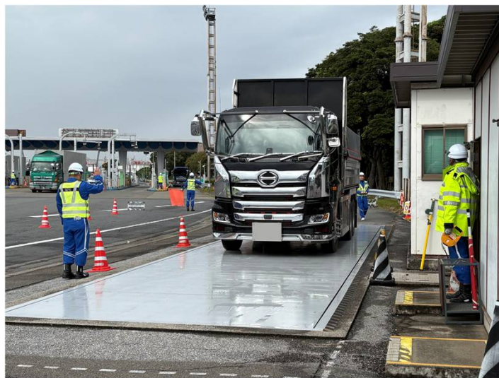
〈台貫による重量計測及び寸法計測風景〉
