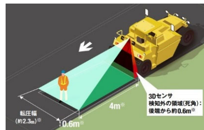
【センサーによる接触防止】
