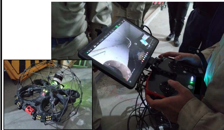
閉塞空間の多い構造物内点検を ドローンを用いて実施
