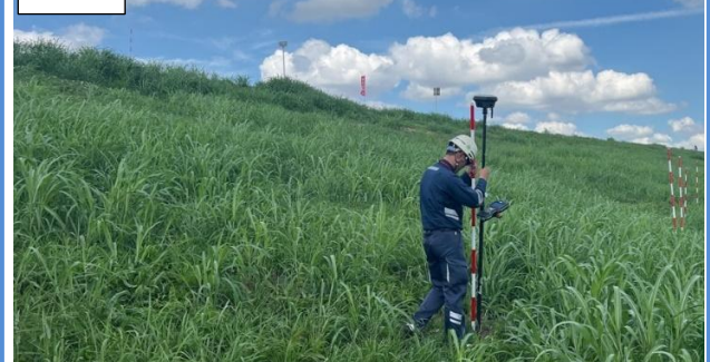
GNSS ロバーによる除草範囲の座標計測
