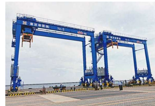
水素換装型トランスファークレーン 荷役機械の脱炭素化を目指し、現在2基導入
