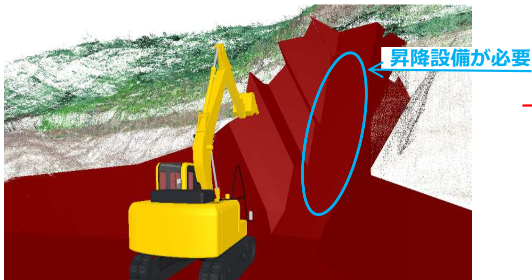
左岸法肩部の掘削 VR画像
