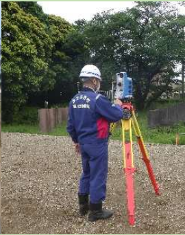
3次元計測機器による起工測量実習
