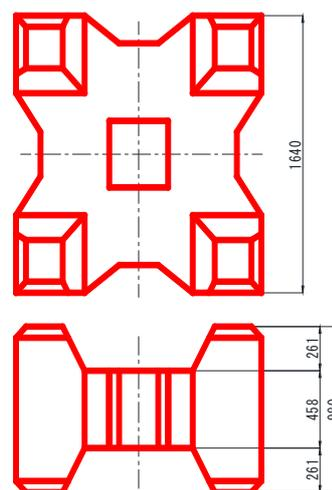
【横断図（根固めブロック工）】
