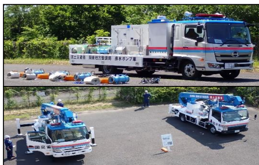
設置場所全景 上:排水ポンプ車 下:照明車
