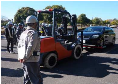
フォークリフト(アタッチメント付)による放置車両移動訓練
