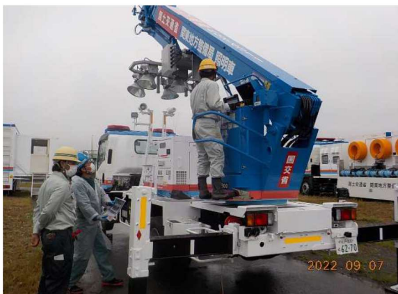
照明車 操作訓練
