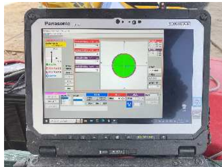
【杭打設管理システムによる施工状況】 【杭心位置をOPに表示したモニター状況】
