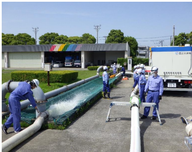
排水ポンプの排水操作（イメージ）
