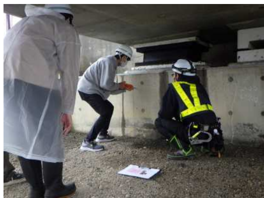
テストハンマーによる 強度推定調査
