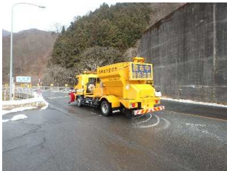
凍結防止材散布状況
