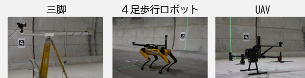
図3 検証実験で使用した三脚、4足歩行ロボット、UAV
