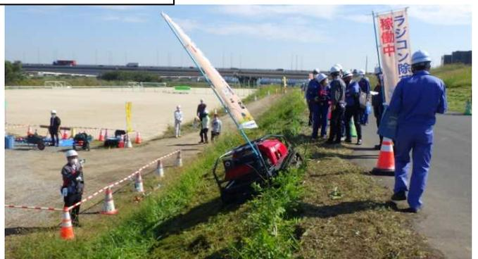
無線遠隔操作が可能となった小型遠隔除草機を活用し、人力で作業していた急勾配箇所を機械で行うことで作業員の安全性を確保できる
