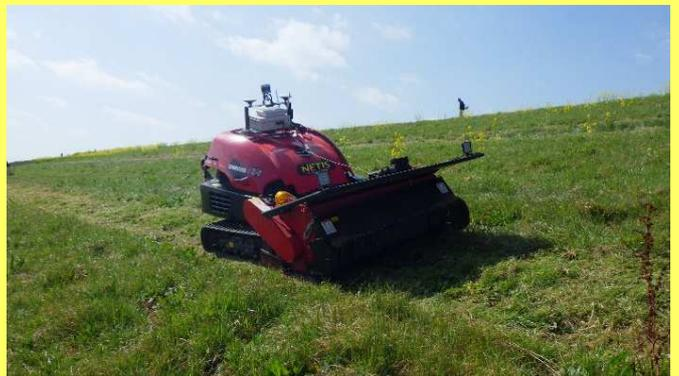
現場で設定した除草範囲を、作業員が搭乗することなく自律走行して除草でき、除草結果（除草面積の自動計算）の出力機能を有する技術
