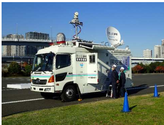
衛星通信車（ドローン空撮映像を 衛星通信により伝送）
