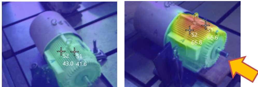
図 8.3-9 不具合事例③-1（左：正常、右：固定子短絡+軸受け（玉、保持器）傷）
