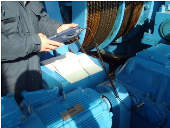
図 2.2-1 振動（加速度）計測状況（計測事例）
