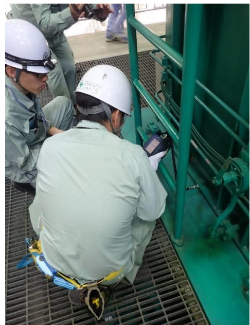
図 3-1 ポータブル振動計（FFT アナライザ付）と振動計測状況
