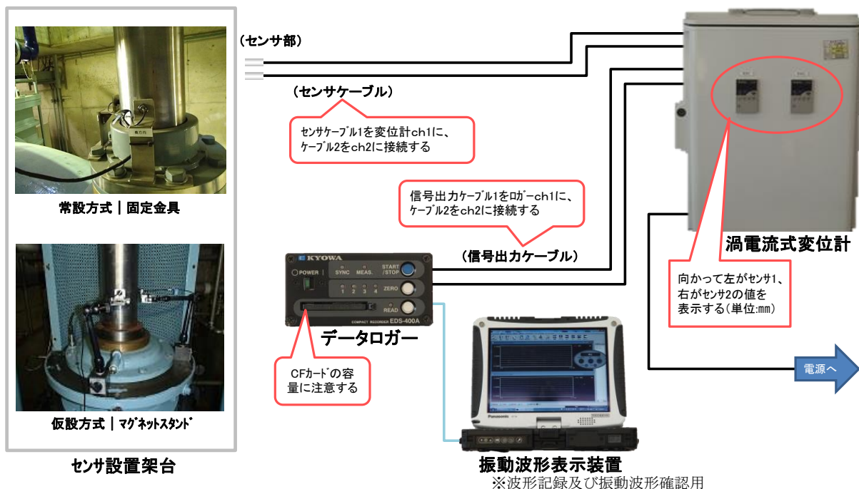
図 2-7 渦電流式変位計による計測機器の構成
