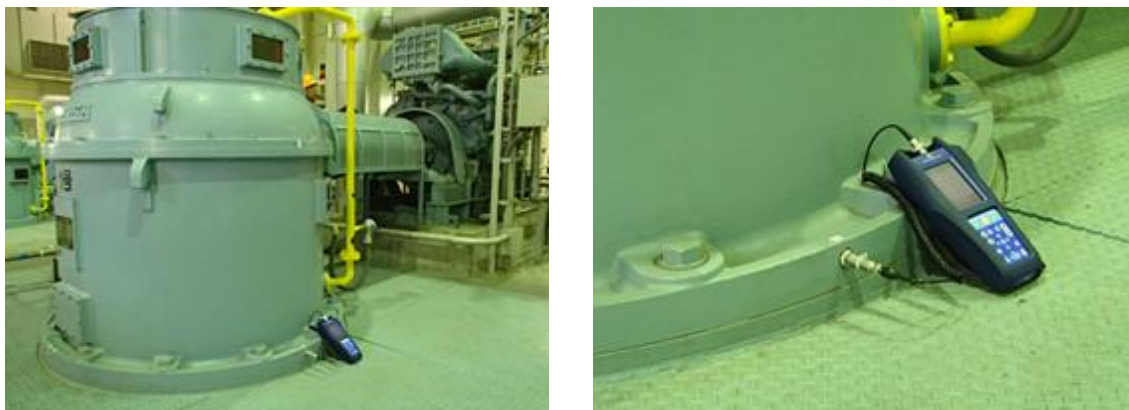
図 3-8 振動（加速度）計測状況（計測事例）
