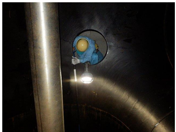
図 4-6 工業用内視鏡撮影の実施事例
