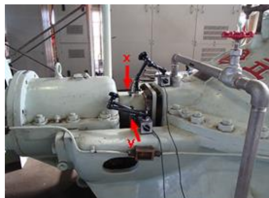
図 2-6 横軸ポンプ設備振動（変位）測定箇所（参考：マグネットスタンド）
