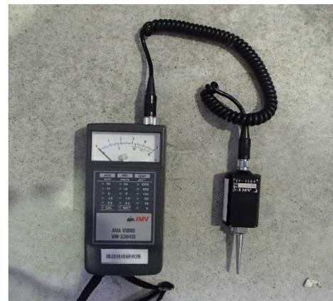
図3-9 ニードル式による計測
