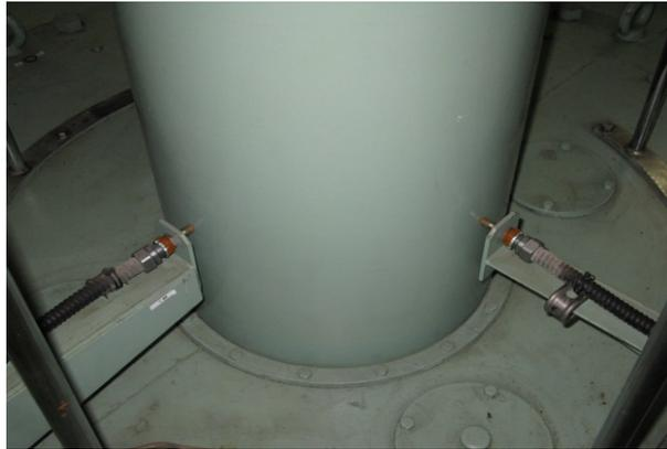
図3-11 非接触式変位センサ設置例
