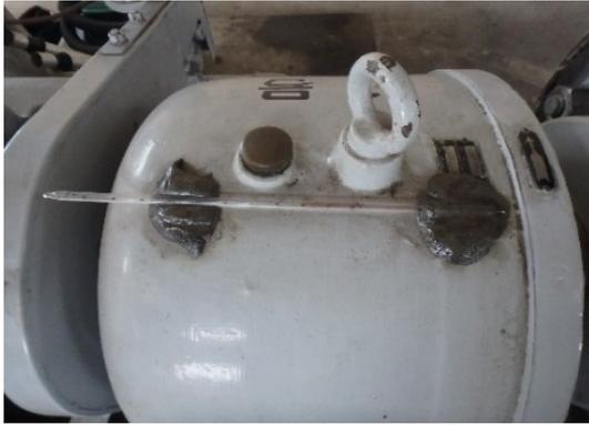
図3-18 棒状温度計による計測
