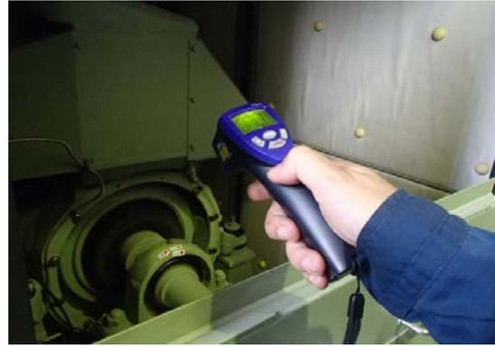
図3-19 非接触赤外線温度計による計測
