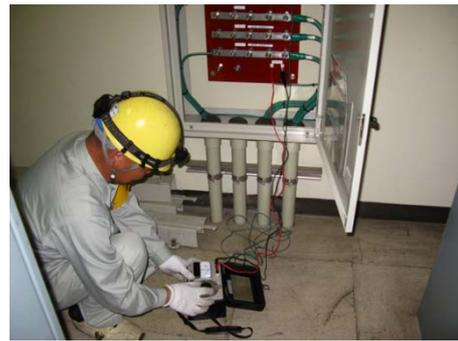
図 3-7 接地抵抗の計測
