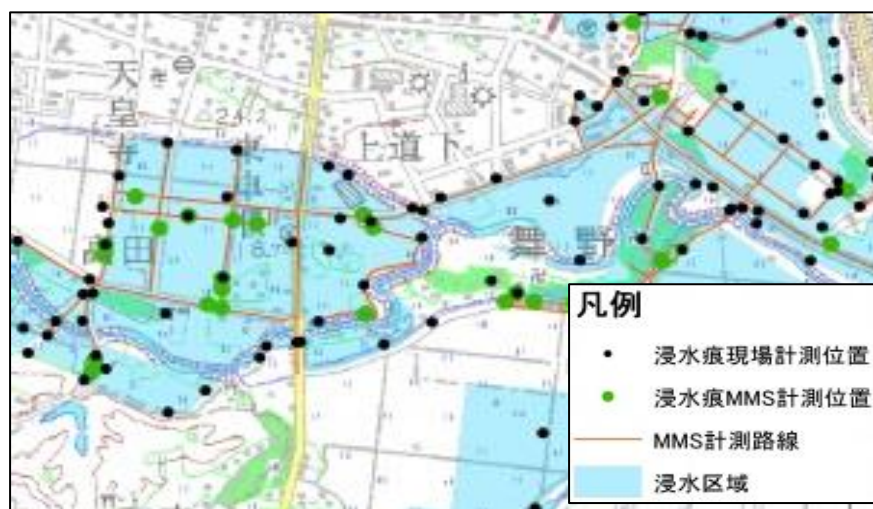
図 4-2 浸水痕現場計測とMMSによる浸水深ポイントデータ位置図
