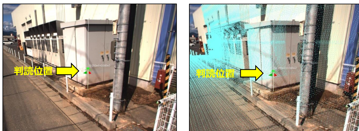
図 4-3 MMS 画像判読の状況（左：画像判読、右：レーザー点群データによる標高読み取り）
