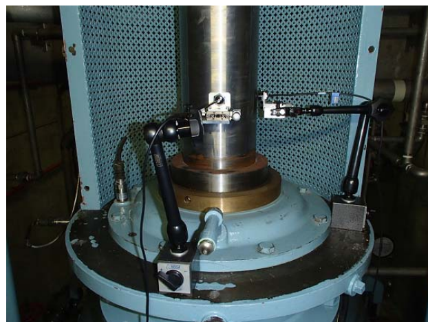
Fig.3 渦電流式変位計センサ部の設置状況
