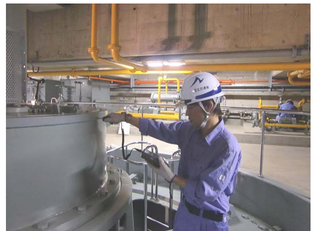
Fig.1 加速度計による測定方法
