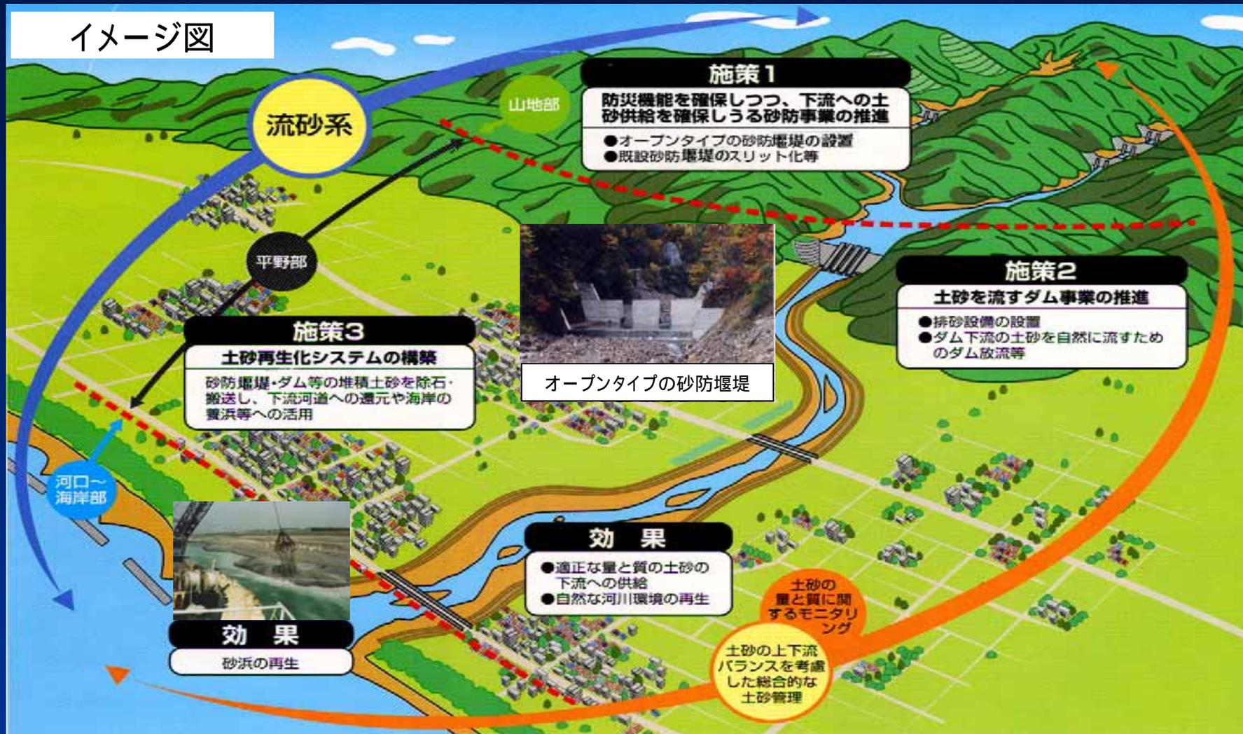
富士川等では、上流部の異常土砂流出、中下流の河床低下、海岸浸食等土砂移動に関わる問題が顕在化してきております。そこで、透過タイプの砂防堰堤の設置、既設砂防堰堤のスリット化等、平常時の土砂の流れを促す対策を進めるとともに、流砂系一貫した土砂移動に関するモニタリングに取り組みます。
