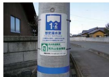
堤防決壊時の想定浸水深や避難場所を電柱に設置 (H21年常陸太田市・ひたちなか市で実施)
