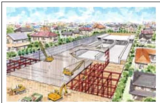
図 開削工法工事イメージ
