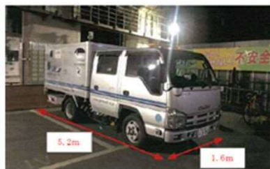
路面下空洞探査車(車載型レーダー)
