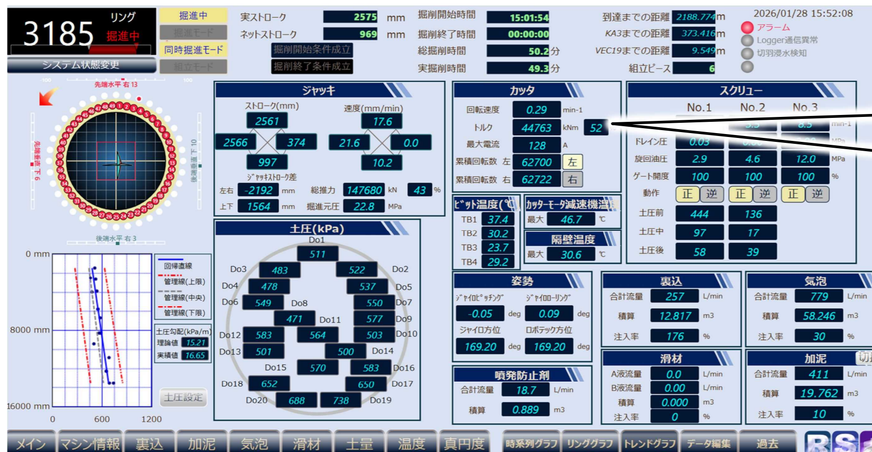
カッタートルクのリアルタイム監視状況
