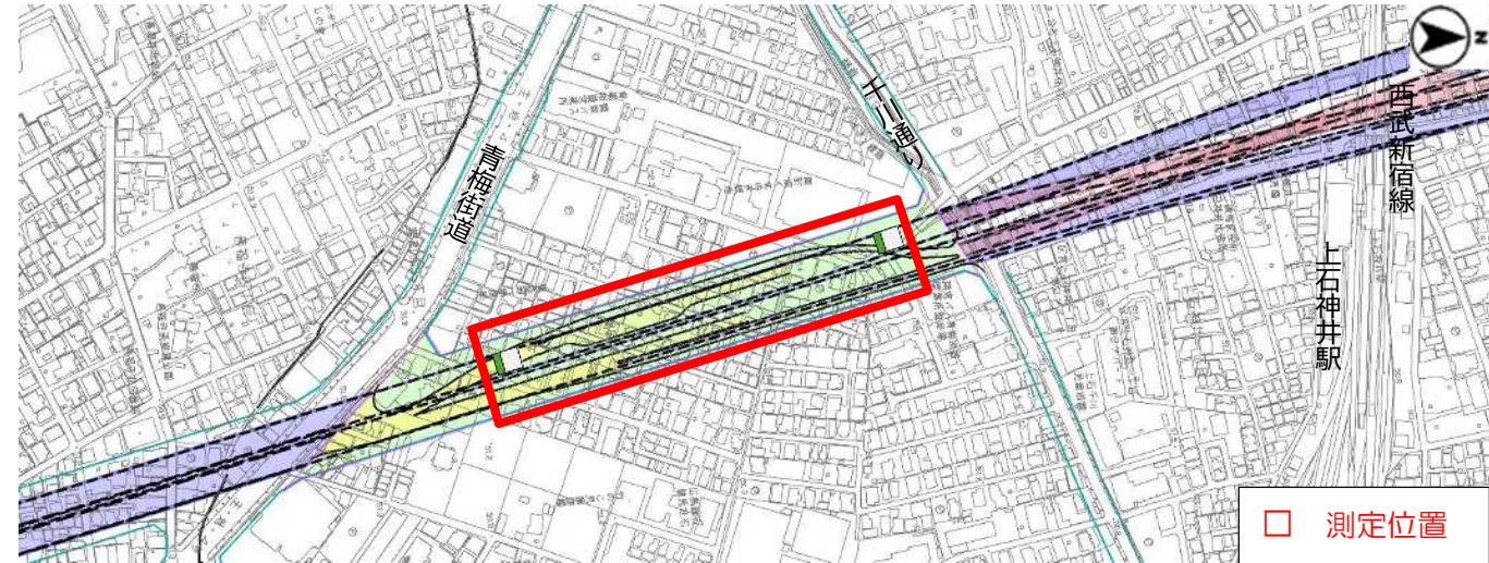
測定位置（進捗に合わせてシールドマシン直上付近を測定）
