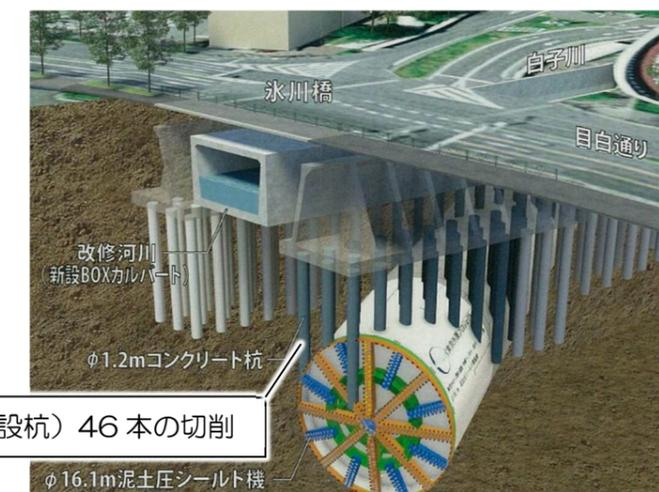
図\_支障物切削状況図
