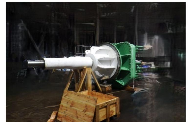
写真\_\_更新予定のモーター駆動軸
