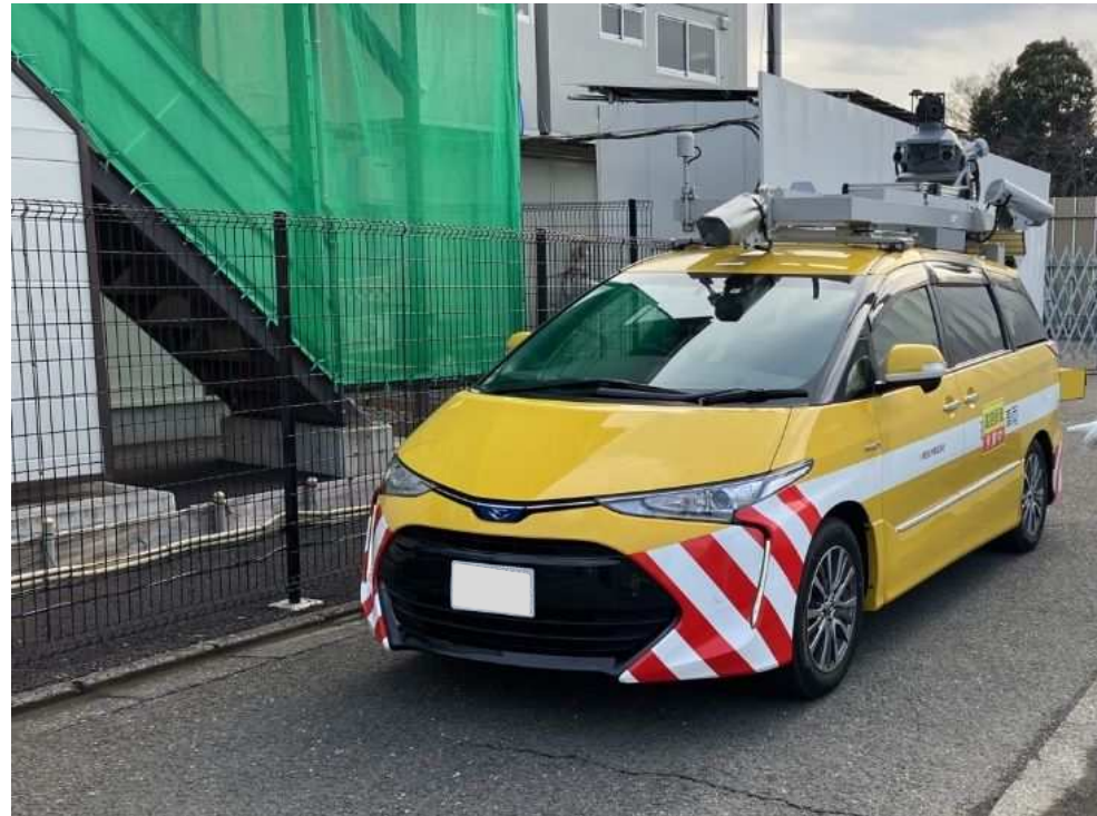
MMS 計測状況
