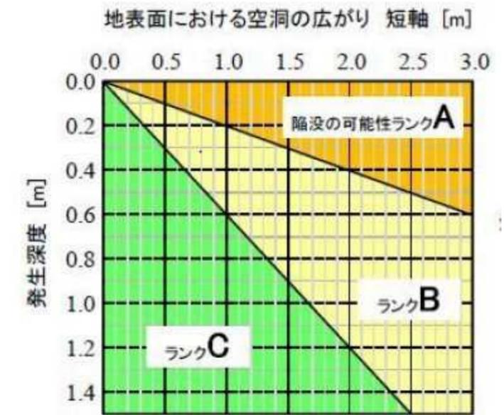
路面陥没発生の可能性評価基準図
