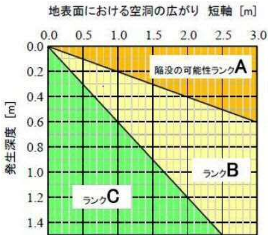
路面陥没発生の可能性評価基準図
