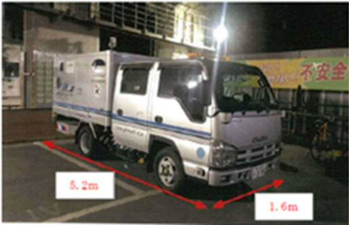
路面下空洞探査車(車載型レーダー)
