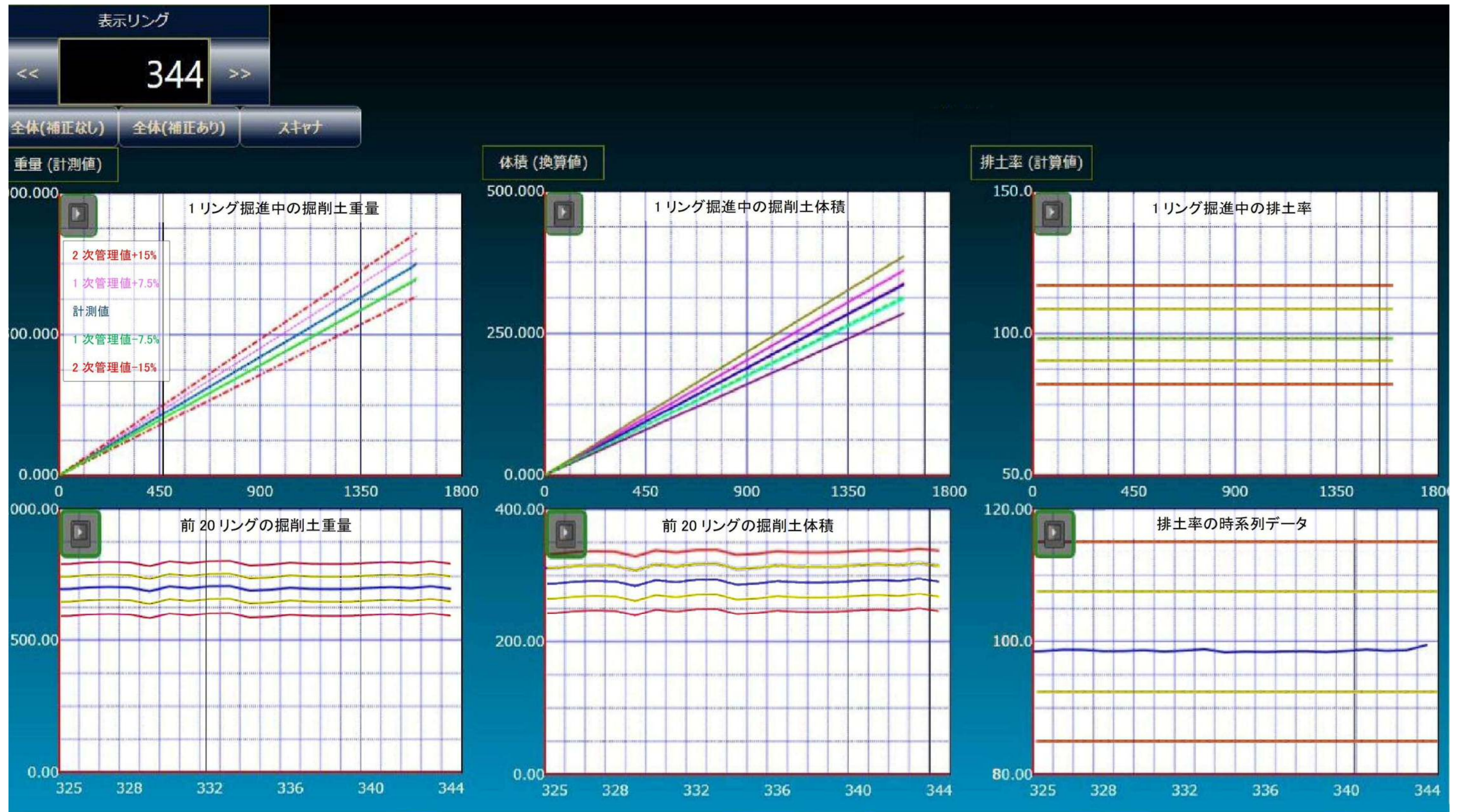
掘削土量 リアルタイム監視(参考)
