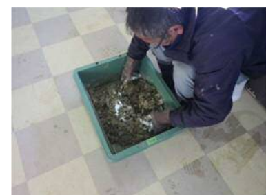
図 3 砂礫土と気泡 (起泡剤+水+空気)混練状況
