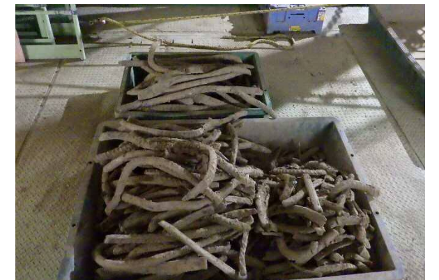
杭切削時回収鉄筋
