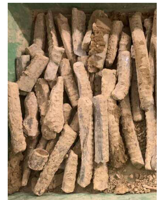
杭切削時回収鉄筋
