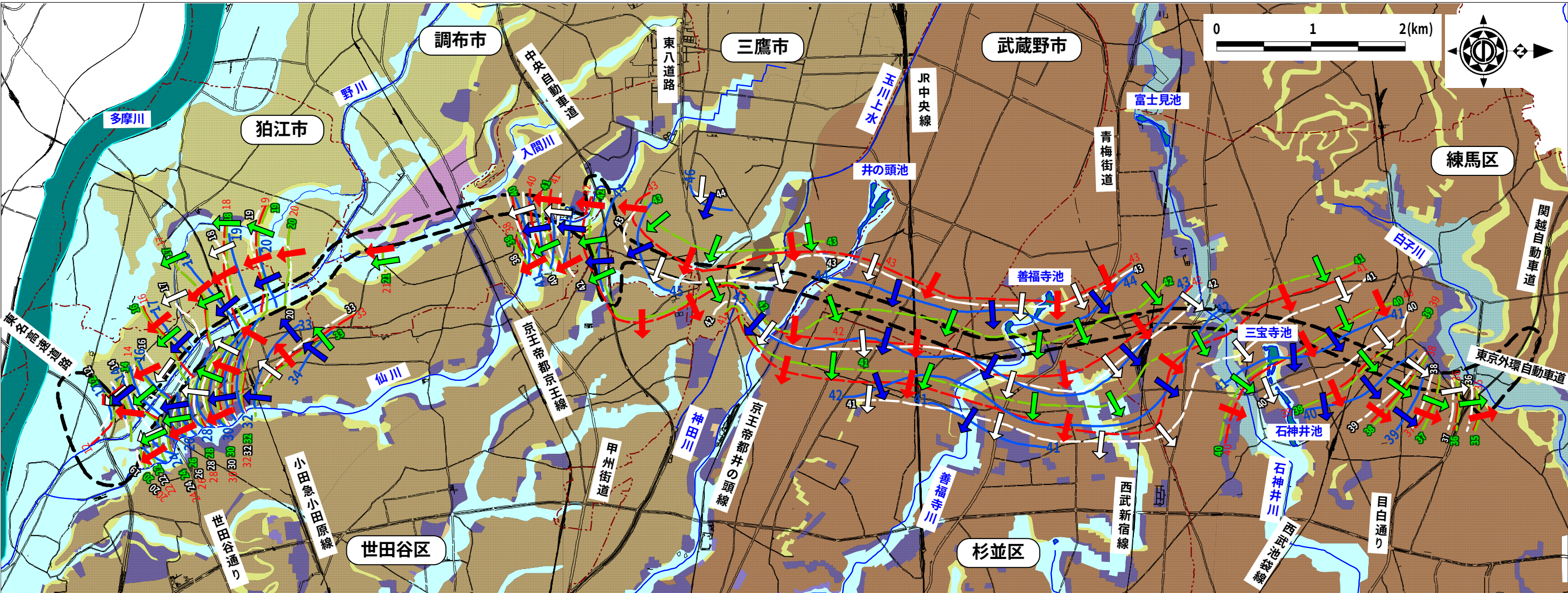
浅層地下水の水位標高と移動方向
