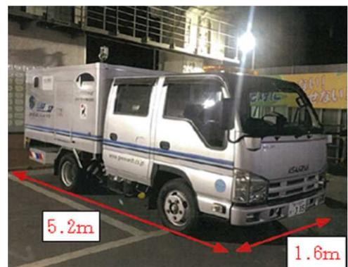
路面下空洞探査（車載型レーダー）
