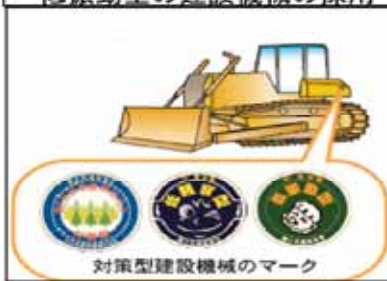
排出ガス対策型・低騒音型・低振動型の建設機械の採用
