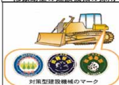
排出ガス対策型・低騒音型・低振動型の建設機械の採用
