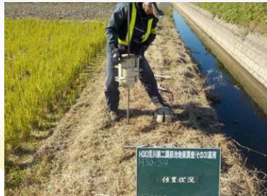
土質調査(電気探査、旧河道の平面分布調査用)
