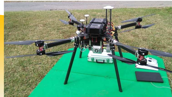
測量(UAVレーザー測量による地形測量)
