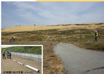
土質調査(電気探査、旧河道の平面分布調査用)
