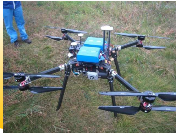
UAVレーザ測量による地形測量
