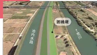
荒川左岸の広い河川敷を調節池にするために造る堤防です。第二調節池は約10m、第三調節池は約7mの高さで造ります。
