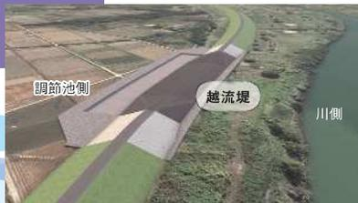
荒川の水位がある高さ以上になった時に、洪水の一部を調節池へ流れこませるために、周囲堤よりも低く設置する堤防です。
