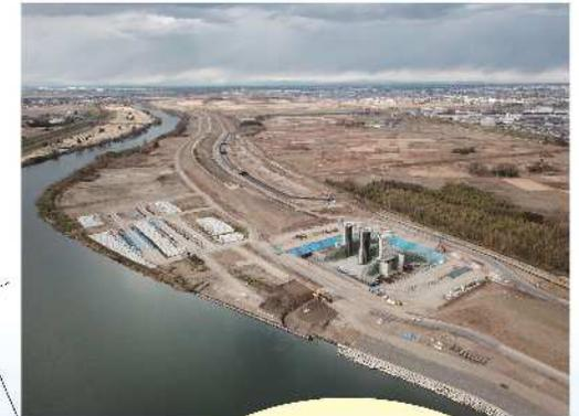
調節池とは大雨等の時、洪水の一部を一時的に貯め、下流の氾濫を防ぐ施設です。現在、「荒川第二・第三調節池」の整備を進めています。
