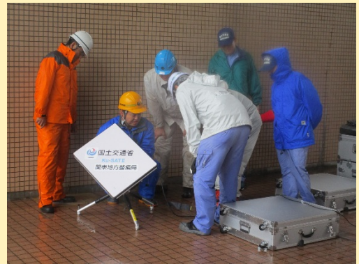
衛星回線を使用して音声・映像を伝えます
