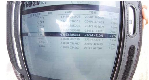
施工管理に伴う測量を、自動追尾式光波測定機（Leica製 TS13）にて行いました。自動追尾式光波測定機は、トータルステーション・リモートコントローラーの2つの機械をBluetoothで接続するため、通常では2人必要な測量作業を1人で行うことができます。これにより、測量業務の省力化・効率化を図ることができました。
