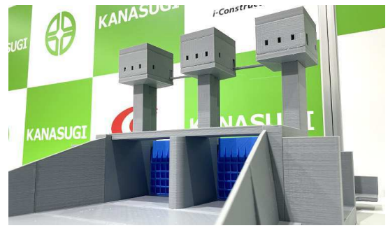
3Dプリンターで出力した荒川第二調節池排水門
